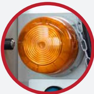
Eine **Blinkleuchte** signalisiert den entleerten BigBag.
