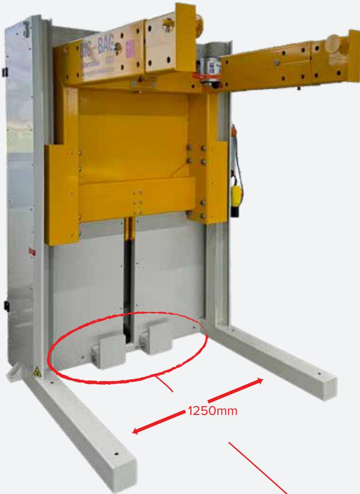
Die Anlage kann alle **Paletten bis** zu einer Breite von **1250 mm** aufnehmen und kann mit einem Hubwagen, Elektro Hubwagen und auch Gabelstapler beladen werden.
