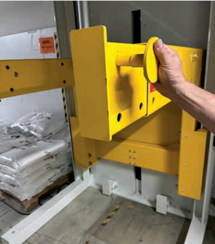
Die **Einhängebolzen** für die BIG BAG Schlaufen können in **verschiedenen Positionen** in die Tragarme eingesetzt werden, z.B. auch von außen. Dies ist bei **niedrigen Deckenhöhen** sehr vorteilhaft. Natürlich lassen sich die Schlaufen des BIG BAG auch direkt über die Teleskoparme schieben.
